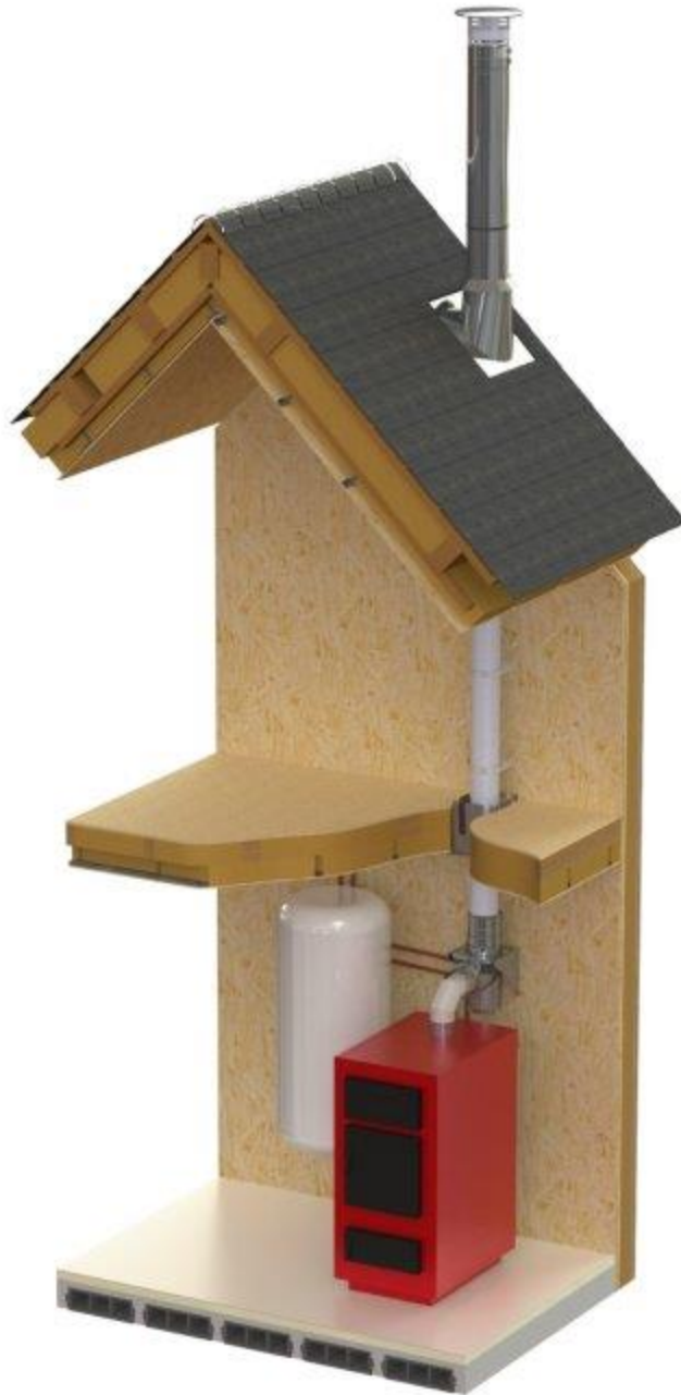
Figure 3 – Principe de montage du procédé en création de conduit (en comble non habitable)
