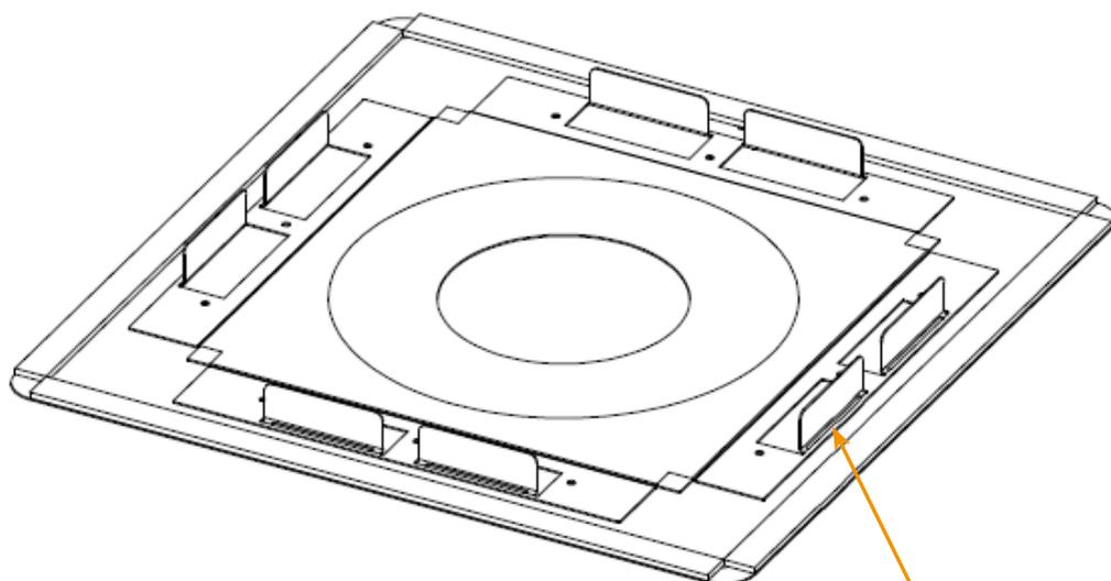
Selon le besoin, à l'aide d'un tournevis déplier ou non les languettes de centrages du bloc isolant
