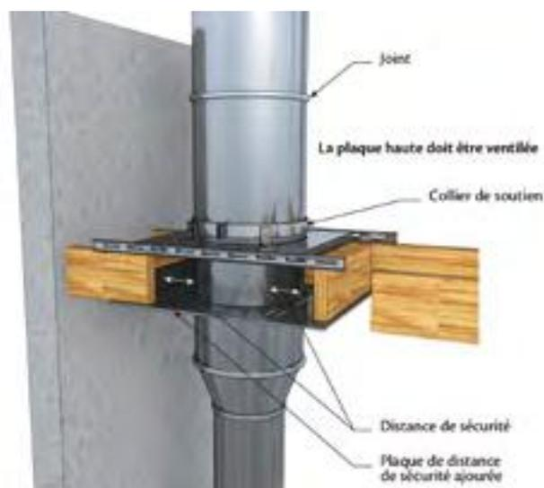
Source : Guide pratique développement durable « Construction d'une cheminée » CSTB
